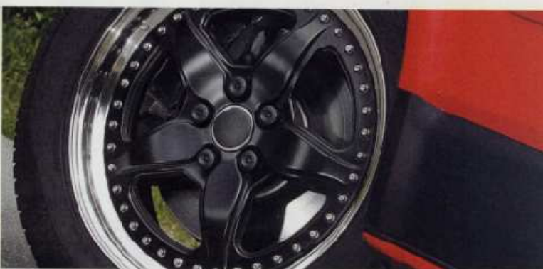
Die Schmidt-„Racelite“-Räder messen 8,5 x 19 Zoll, die eher griparmen Yokohamas 255/50 R 19. Mittels Fernbedienung lässt sich das Luftfahrwerk einstellen, Zusatzanzeige in der A-Säule
